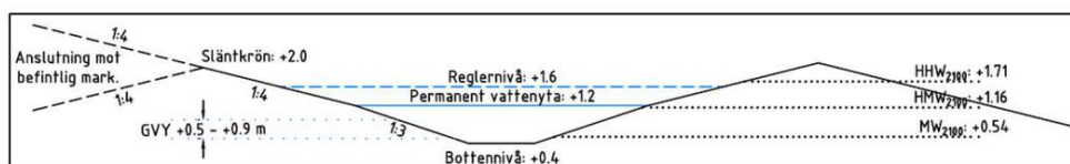
Figur 27: Normalsektion dagvattendamm. Ramboll, 2023).
